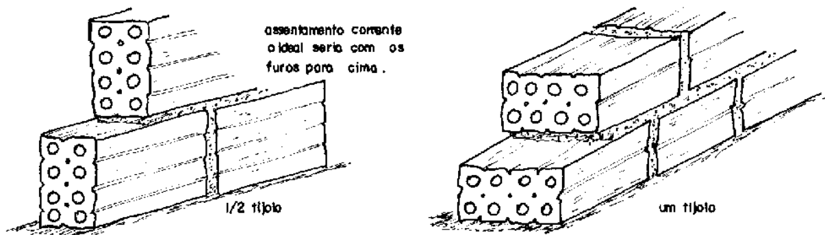
Figura 1 - Execução de alvenaria utilizando tijolos furados.
